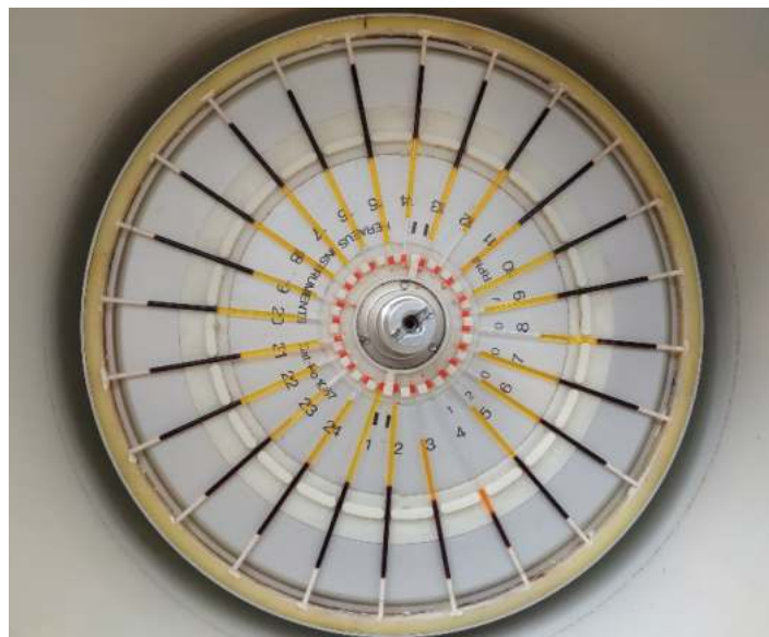
Figura 1. Sangre de aves en tubos capilares heparinizados tras su centrifugación, donde se observa la fracción celular (rojo oscuro) y la plasmática (amarilla). La parte blanca es una especie de plastilina que sella el tubo y evita la salida de la sangre durante la centrifugación. Fotografía: Jaime Muriel.
